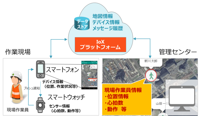
Fig. 3: 現場作業員見守りシステム
